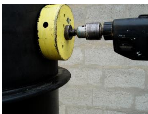
Lyukmarása megfelelő szerszám segítségével
